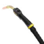
Exor MIG 4.0G 2 gorionik – gasno hlađeni DX Radni ciklus: 60% pri 360 A Prečnik žice: 0,8–1,6 mm (0,035–1/16 in.) Način hlađenja: Vazdušno
