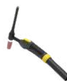
Exor TIG gorionik SR 17 Radni ciklus: (AC) 35% pri 120 A | (DC) 35% pri 170 A Prečnik elektrode: 0,5–2,4 mm Način hlađenja: Gasno (vazdušno)
