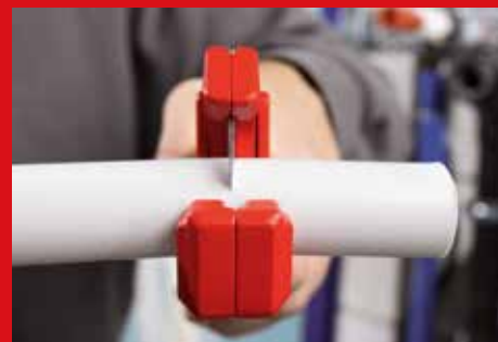
Omogućava ravan rez pod pravim uglom
