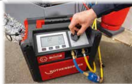
Funkcija samočišćenja za potpuno pražnjenje rekuperatora
